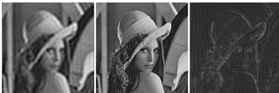
Obrázek 8: Vliv filtrace na výsledný obraz – dolní propust, původní obraz a horní propust.
