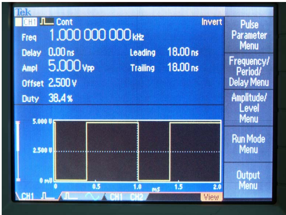
Obr. 2: Testovací signál přiváděný na časovač svorkovnice X2
