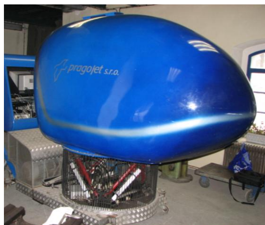
Obr. 4: Příklady simulátorů: a) řídicí simulátor bojového vozidla pěchoty, b) simulátor lehkého sportovního letadla.
