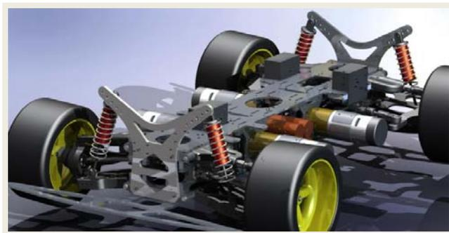
Fig. 1.: Main body frame (CAD render)
