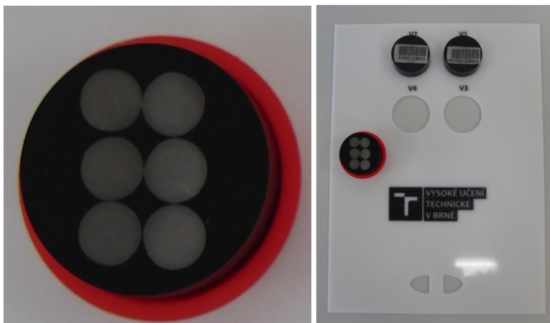
Obrázek 1: snímek kotouče se šesti dráty (vlevo) a snímací šablona (vpravo)
