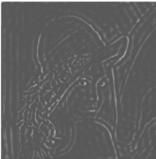
Obr. 2c Filtrovaný obraz pouze frekvenčním filtrem, K=4 .
