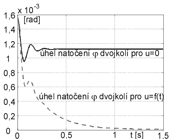
Obr. 7 Úhel natočení dvojkolí od radiální polohy
