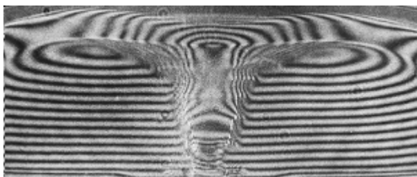
Obr. 7: Výřez interferogramu pinč výboje. Velikost výřezu je 523x220 pixelů což odpovídá rozměrům 158x68 mm 2 .
