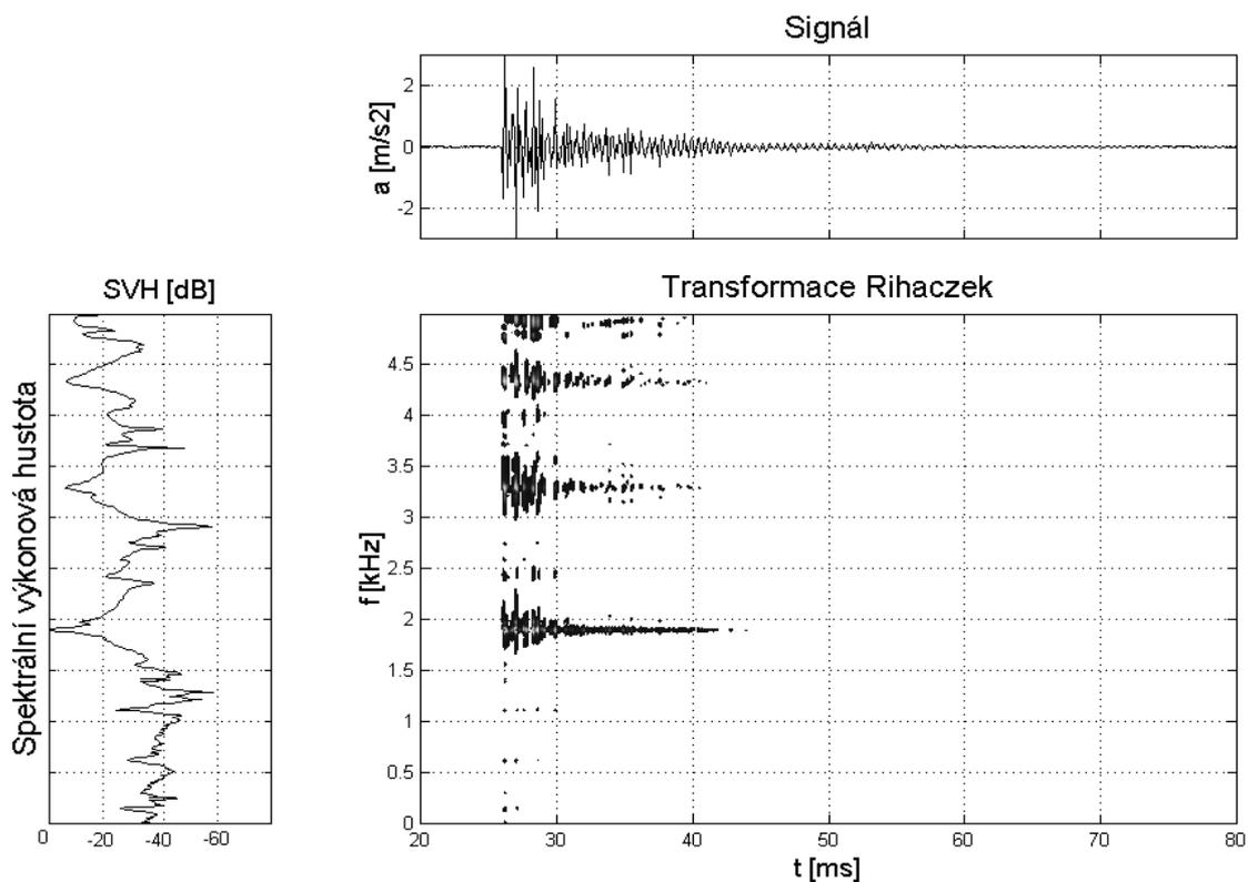
**Obr. 6** Snímač umístěný na patě kolejnice kolejového roštu s betonovými pražci, časově frekvenční analýza metodou Rihaczek
