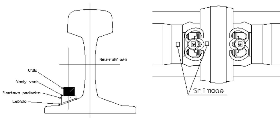
**Obr. 1** Umístění snímačů na kolejnici a pražci
