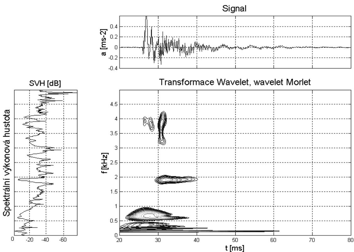
**Obr. 5** Snímač umístěný na pražci v blízkosti kolejnicového upevnění kolejového roštu s betonovými pražci, časově frekvenční analýza metodou Wavelet
