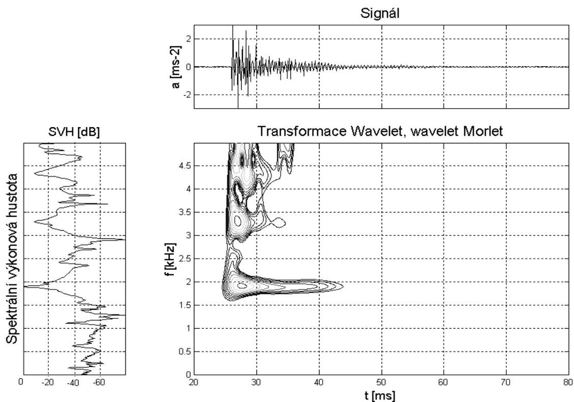
**Obr. 4** Snímač umístěný na patě kolejnice kolejového roštu s betonovými pražci, časově frekvenční analýza metodou Wavelet
