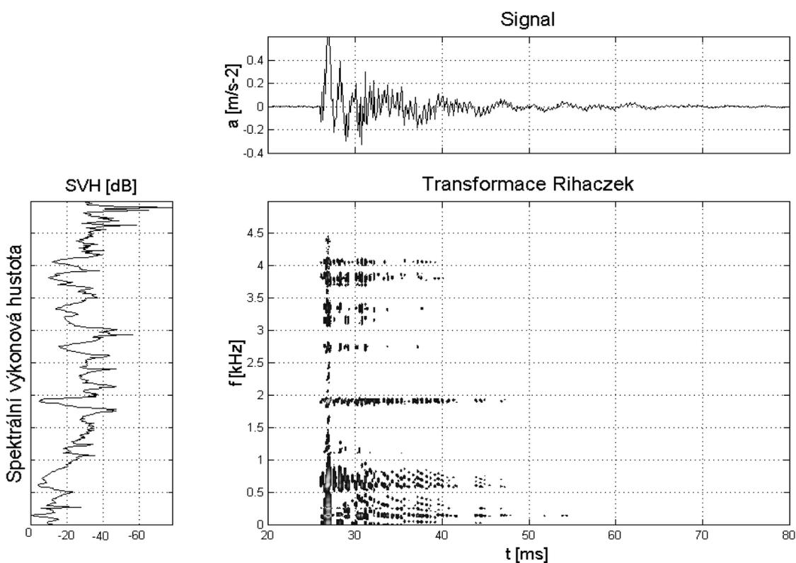
**Obr. 7** Snímač umístěný na pražci v blízkosti kolejnicového upevnění kolejového roštu s betonovými pražci, časově frekvenční analýza metodou Rihaczek
