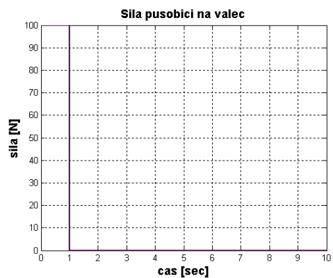
Obrázek 6: Časový průběh síly působící na píst.
