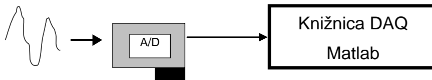
Obr. 7. Spôsob akvizície dát s využitím prostredia Matlab a zvukovej karty
